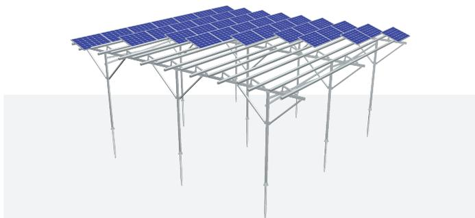
MRac农业架台光伏支架系统II 主要适用于农业光伏电站的安装，节约了土地资源，解决了光伏发电与种植使用的冲突，根据各种电池板排版、植物所需的日照量和农耕机器入口尺寸等来设计系统结构，提供合适的支架设计，预装程度高，施工便捷。
